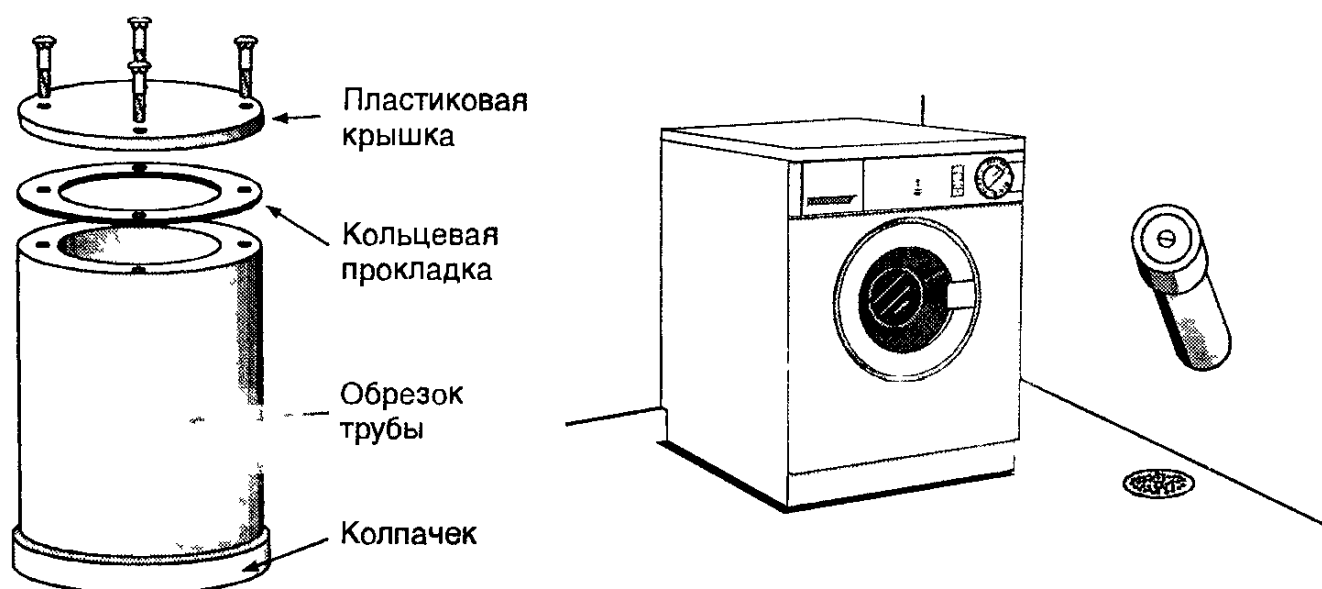
Рис. 2.25. Оборудование фальшивого стока
